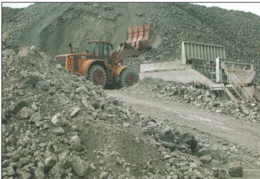
Figure 3 – Partenariat entre les Carrières du Boulonnais et la société Gagneraud Industries par le biais de Valsid (Valorisation des laitiers sidérurgiques du Dunkerquois), pour la transformation de laitiers sidérurgiques en granulats pour bétons, entre autres Partnership between the Boulonnais quarries and the Gagneraud Industries company through the intermediary of Valsid (Recycling of steels slags from the Dunkirk area), for the transformation of steel slags into aggregates for concrete manufacturing, among other things
