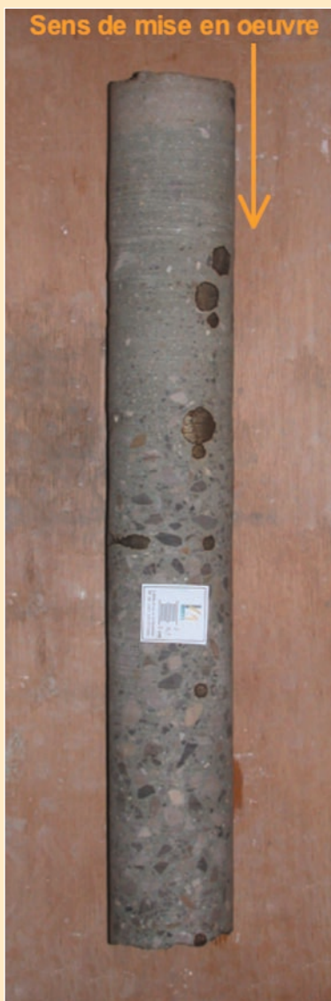
Phénomène de ségrégation lié à un excès d'eau de gâchage associé à une vibration excessive
