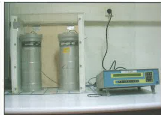
Figure 2 – Calorimètres de Langavant utilisés pour la mesure de chaleur d'hydratation des ciments
