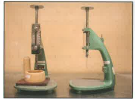
Figure 1 – À gauche, sonde de Tusschenbroeck pour la mesure de consistance normale, à droite, prismomètre de Vicat
